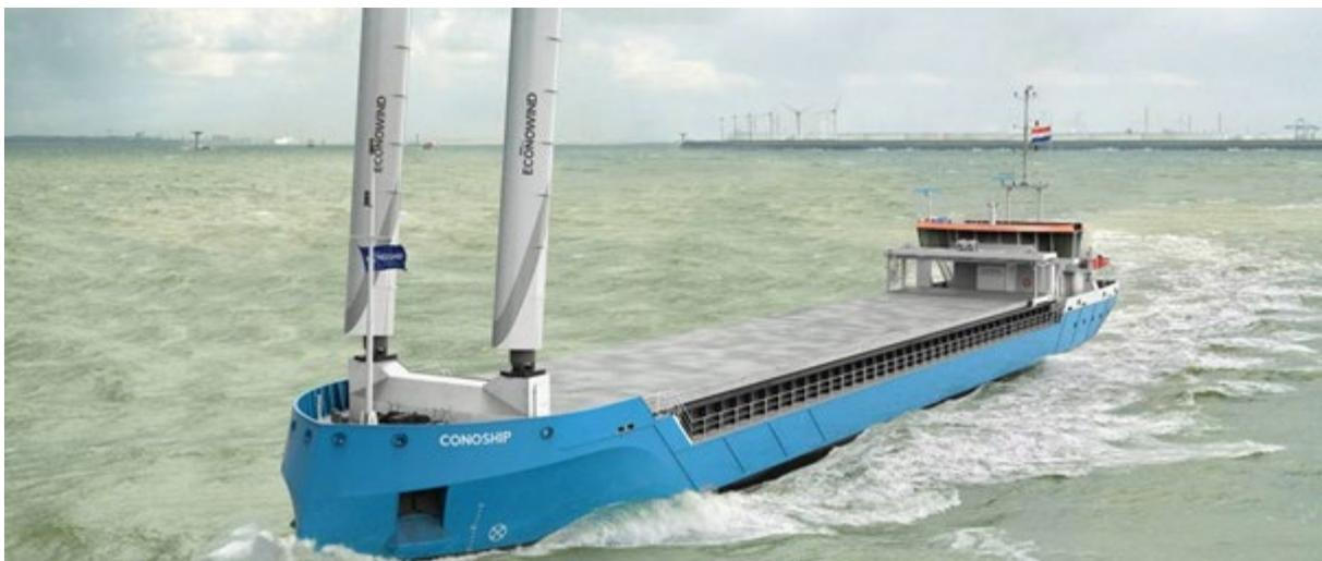
Figure 20 : Caboteur propulsé par les ailes d'eConowind, © Conoship
